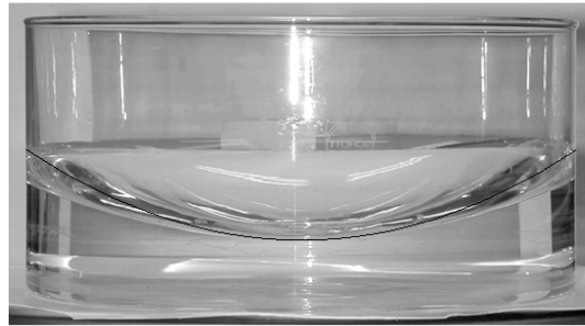
FIG. 7.1 – Ecoulement avec des lignes de courant courbées.
